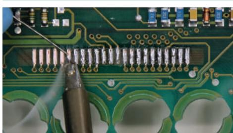
Per la corretta saldatura del nuovo display, aggiungere dello stagno sui contatti e rimuovere eventuali eccessi con una treccia dissaldante.
