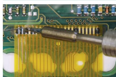
Saldare singolarmente i pin dell'FPC sulla scheda del contachilometri con un saldatore con punta sottile, a una temperatura di 350°C.
