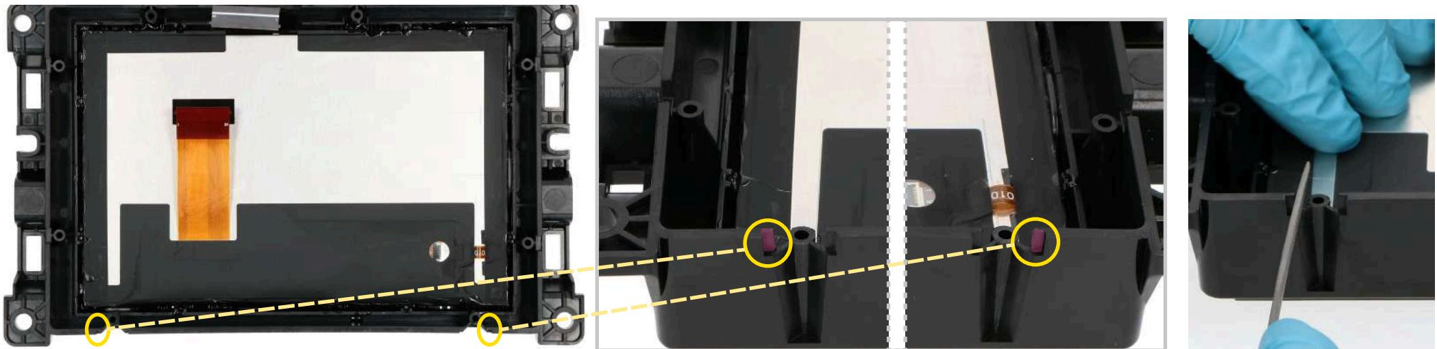
SULLA PARTE INFERIORE DELLA CORNICE DEL DISPLAY: Con una lima eliminare le porzioni di plastica nei punti evidenziati.
