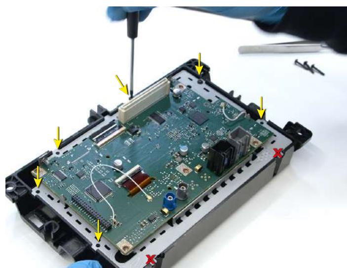
Per fissare la ghiera, utilizzare le 6 viti fornite con il nuovo display.
