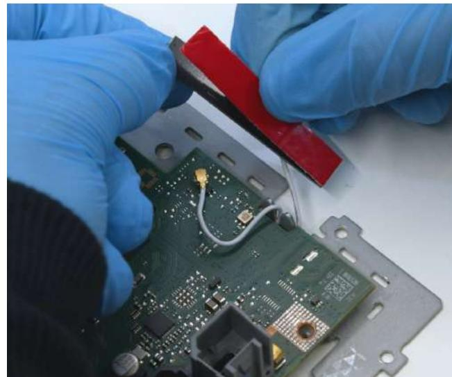
Sostituire l'adesivo con quello fornito con il display.
