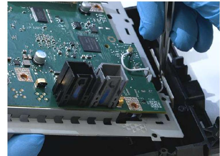
Fissare l'antenna nella posizione di origine.
